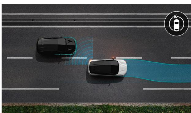
**sensore angolo cieco con sistema di controllo attivo**
